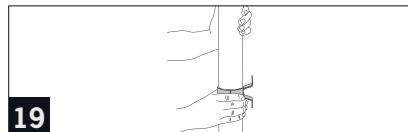
Det øverste rørlammeret monteres like under bendene på nedløpsrøret, slik at det spenner rundt røret. Det nederste rørlammeret monteres slik at det ikke spenner om røret. dette for at nedløpsrøret skal kunne eksplandere. Monteres med en avstand på ca. 2 meter.
