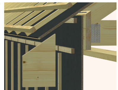
Overgang vegg/tak med løst utstikk
