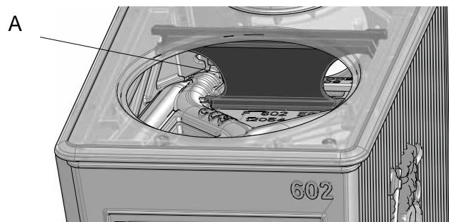
Fig. 27 Byte av rökvänderplatta
